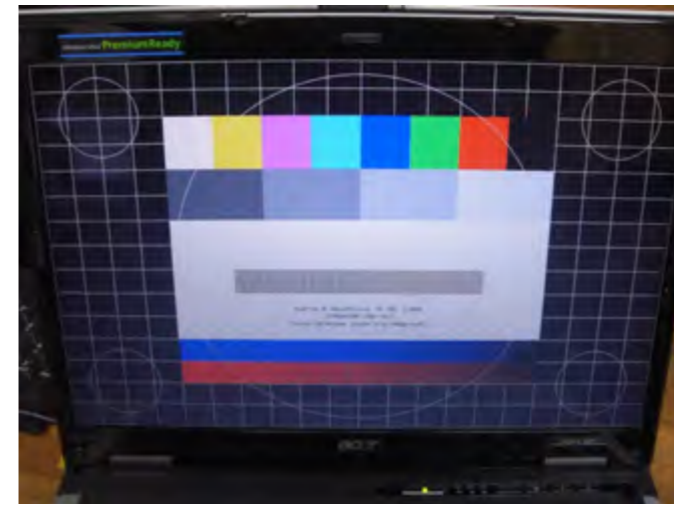
Abbildung 6: Test des Displays auf Pixelfehler
