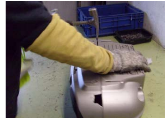
Abbildung 2: Lösen von Schraubverbindungen (links), zerstörende Demontage mittels Hammer (rechts)
