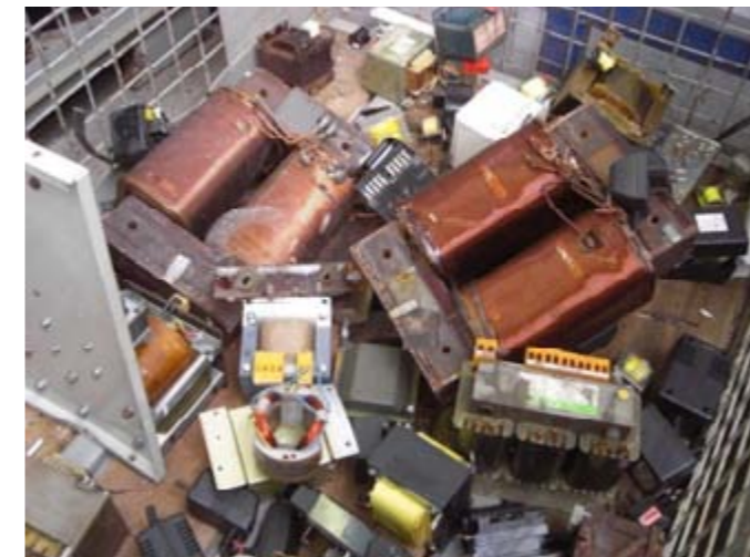
Abbildung 4: Kupferreiche Fraktion (oben), Kunststofffraktion (unten)
