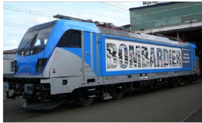
Abb 2.: TRAXX F140AC Last Mile Lokomotive
