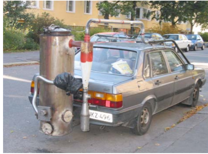
Abbildung 3: Durch Holzvergaser angetriebenes Auto in Helsinki (Finnland)
